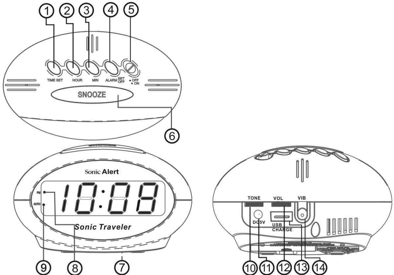
Les caractéristiques du produit figurent dans le schéma ci-dessus :
