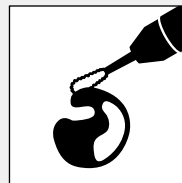
4. Travaillez l'ébauche à l'aide des fraises spéciales.
