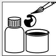
4. Vitrifiez la surface à l'aide des laques de silicone signo de vulcanisation à chaud ou avec une laque séchante à l'air.
