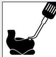
4. Eliminez les irrégularités, trous, cannelures etc. à l'aide de la cire de correction.
